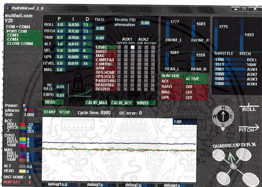
รูปที่ 3.19 การปรับค่า PID ของบอร์ด MultiWii ให้มีเสถียรภาพ
