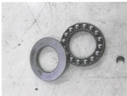
รูปที่ 5.9 ตลับลูกปืนกันรุนที่ติดตั้งบริเวณจุดหมุน
