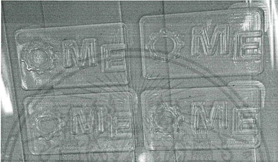
รูปที่ 4.3 ชิ้นงานที่ได้จากการฉีด F_c = 122.3 \text{ kN} , L = 27.2 \text{ mm}
