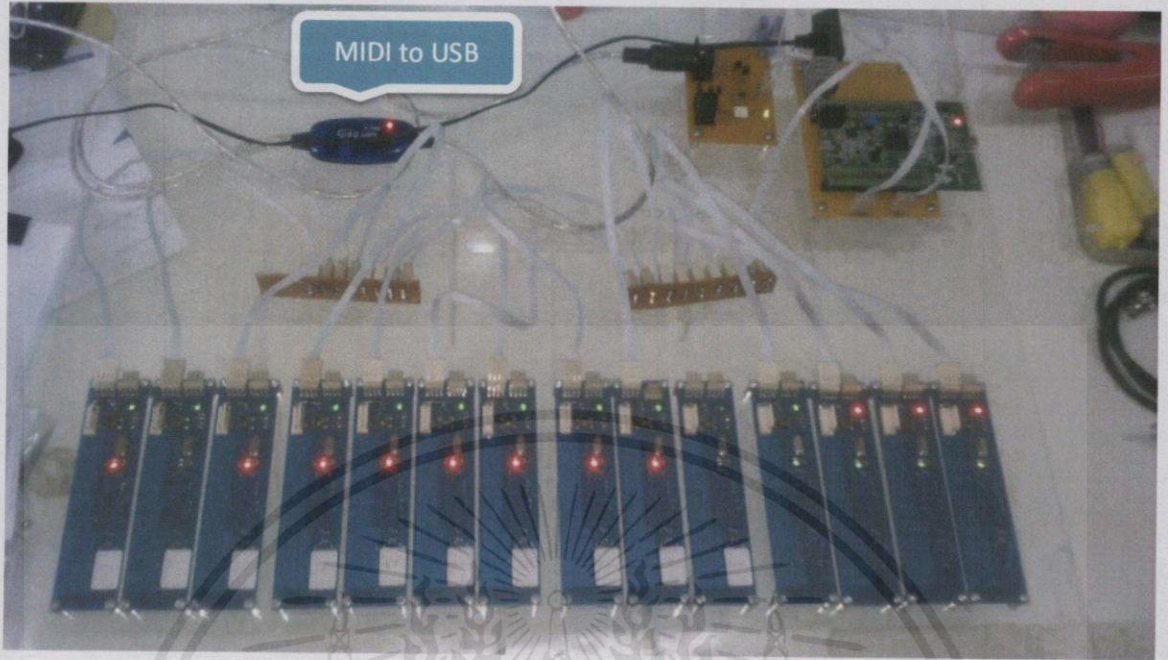
รูปที่ 4.14 ระบบเชื่อมต่อกับคอมพิวเตอร์ผ่าน MIDI to USB
