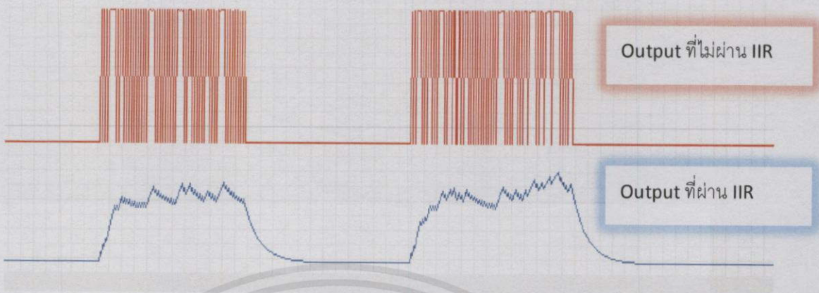
รูปที่ 3.25 กราฟแสดงความแตกต่างระหว่างข้อมูลการวัดที่ไม่ผ่าน IIR Low-pass filter กับผ่าน IIR Low-pass filter
