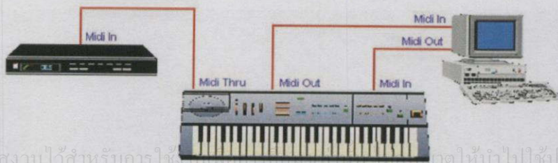
รูปที่ 2.17 ตัวอย่างการเชื่อมต่ออุปกรณ์ MIDI ที่มากกว่า 2 ชิ้น โดยใช้ MIDI Thru
