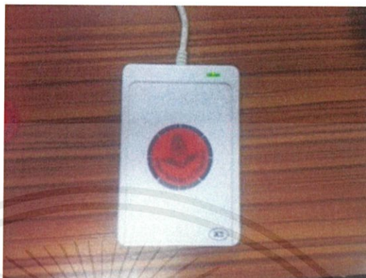
รูปที่ที่ 4.6 สัญญาณไฟสีเขียวเมื่อเครื่องอ่าน-เขียนเอ็นเอฟซีตรวจเจอเอ็นเอฟซีแทก
