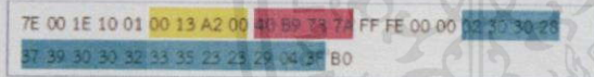
รูปที่ 3 ตัวอย่างPacketข้อมูลในโหมดAPI ของฝั่งส่งตัวอย่างข้อมูลฝั่งส่งที่สร้างขึ้นมาในรูปแบบโปรโตคอล
