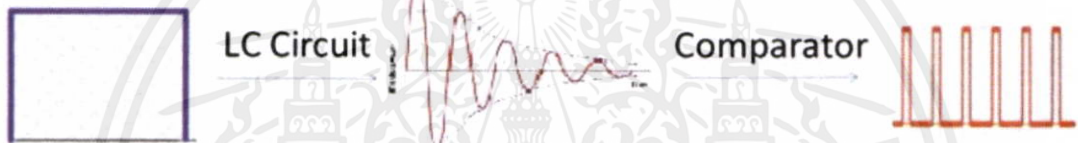
รูปที่ 3.5 รูปคลื่นที่ Input และ Output ของวงจร Comparator
