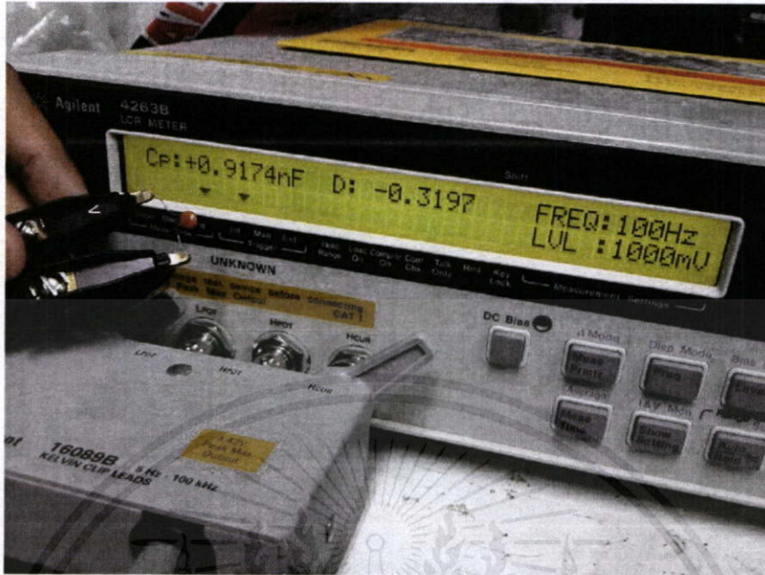
รูปที่ 4.14 การวัดค่าของตัวเก็บประจุขนาด 1 nF
