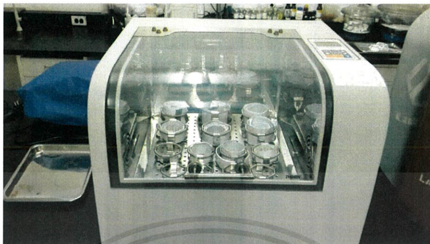
รูปที่ ค.6 เครื่องเขย่า (ZHICHENG รุ่น ZHWY-100B)
