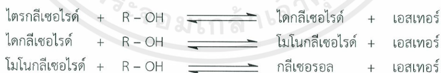
รูปที่ 2.2 ปฏิกิริยาย่อยของปฏิกิริยาทรานส์เอสเทอร์ฟิเคชัน
