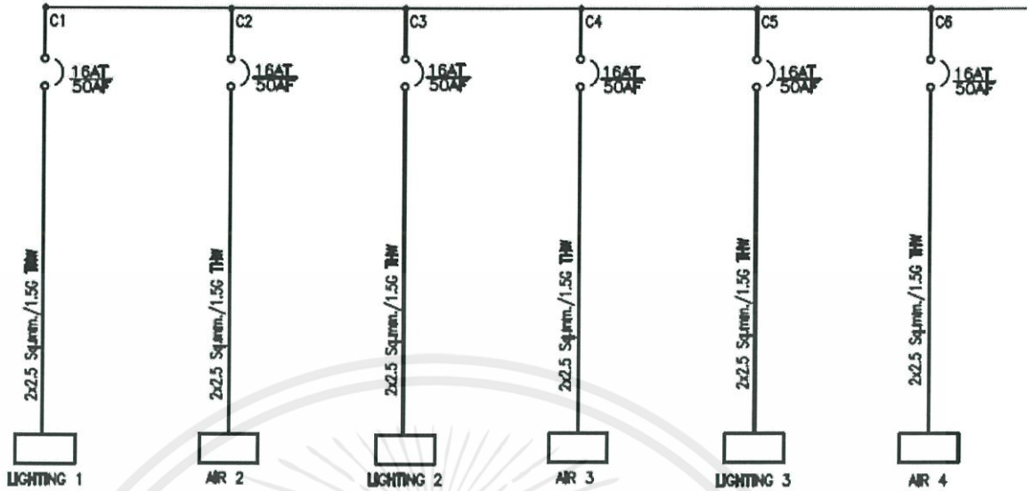
รูปที่ 4.5 รูปขยายของวันไลน์ไดอะแกรมของตู้ LP2 วงจร(เซอร์กิต)ที่หนึ่งถึงหก
