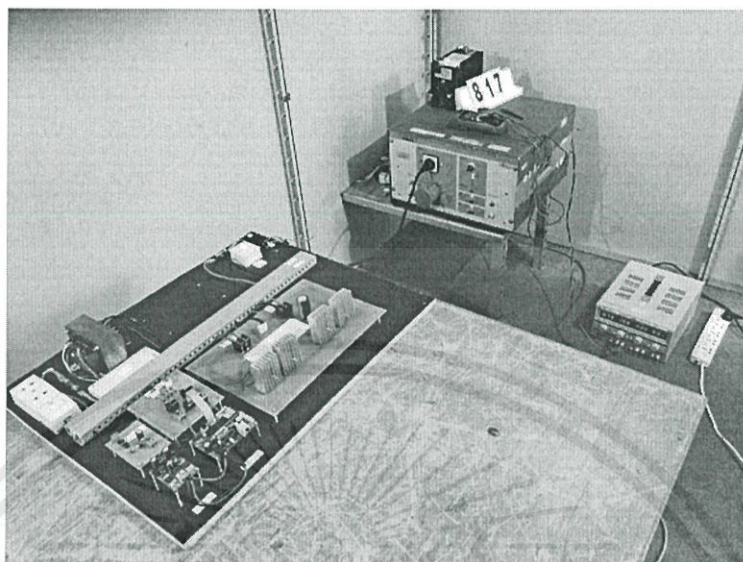
รูปที่ 4.15 การติดตั้งอุปกรณ์เพื่อทดสอบกรณีไม่มีภาระทางไฟฟ้า
