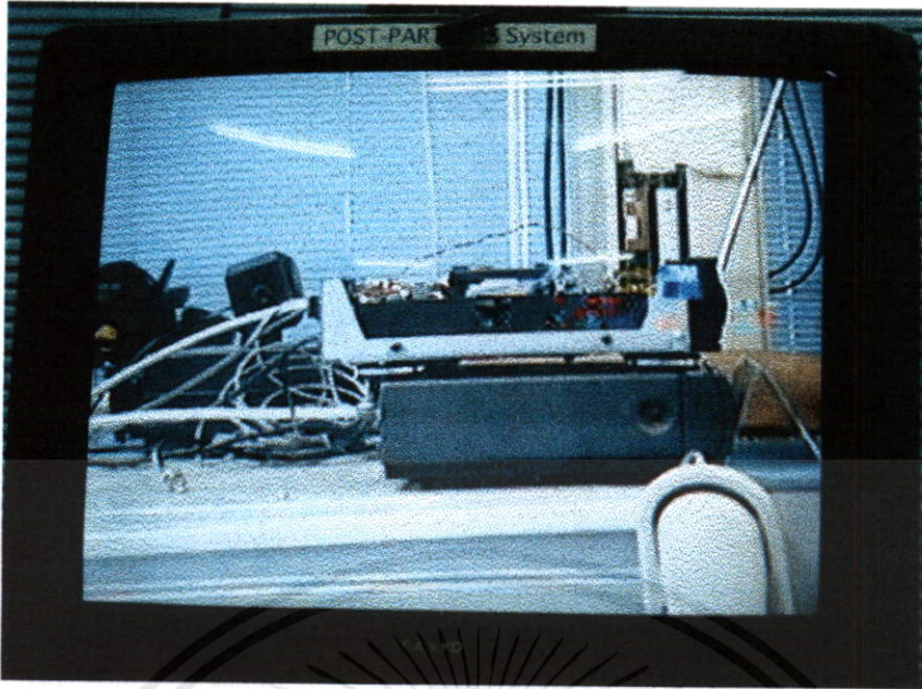
รูปที่ 4.28 แสดงภาพทางด้านรับผ่านจอโทรทัศน์ จากการทดลองส่งในลักษณะวนกลับสัญญาณ มีค่าอัตราผิดพลาด หรือ BER = 2.51E-05 คุณภาพของภาพที่ได้รับ บล็อกสีปนขึ้นมาในภาพที่รับมากขึ้นและมีความล่าช้าของภาพเคลื่อนไหวมากขึ้น
