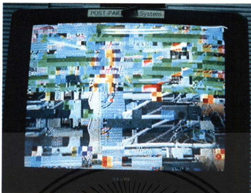
รูปที่ 4.30 แสดงภาพทางด้านรับผ่านจอโทรทัศน์ จากการทดลองส่งในลักษณะวนกลับสัญญาณ มีค่าอัตราบิตผิดพลาด หรือ BER = 9.79E-03 คุณภาพของภาพที่ได้รับมีบล็อกสีปนเป็นจำนวนมากและมีความล่าช้าของภาพเคลื่อนไหวอย่างมาก มีการหยุดนิ่งของภาพเป็นบางครั้ง
