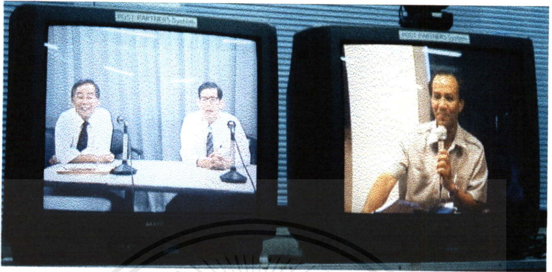
รูปที่ 4.24 แสดงภาพขณะทำการสนทนาผ่านวงจรการสื่อสารดาวเทียม JCSAT-3 ระหว่าง KMITL กับ CRL คุณภาพของภาพและเสียงมีความคมชัดและชัดเจนดีมาก (ค่ากำลังส่ง 38.2 dBm., อัตราความเร็วในการส่งข้อมูล 1536 kb/s, BER = 0.00E-08)
