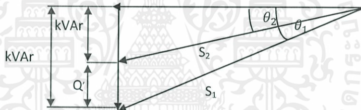
รูปที่ 2.5 สามเหลี่ยมกำลังไฟฟ้าก่อนและหลังปรับปรุงตัวประกอบกำลังไฟฟ้า
