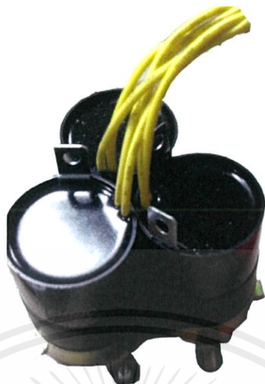
รูปที่ 4.4 ตัวเก็บประจุ 90 ไมโครฟารัดของวงจรดีซี-ดีซีคอนเวอร์เตอร์สำหรับเครื่องอัดประจุแบบฟิลล์
