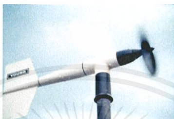
รูปที่ 2.2 ตัวอย่างเครื่องวัดความเร็วลมแบบใช้ใบพัด [12]
