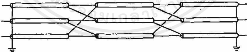
รูปที่ 2.4 การเชื่อมต่อเปลือกสายแบบไขว้ โดยไม่มีการสลับสายระหว่างเฟส (Transposition)
