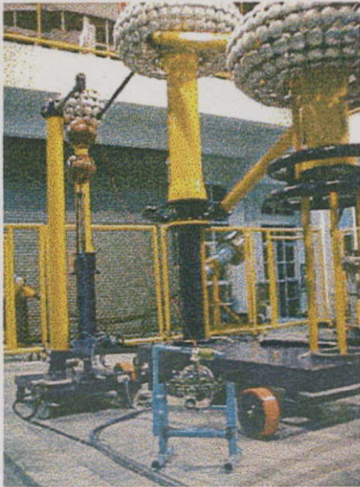
รูปที่ ก-3 การวัดแรงดันไฟฟ้าแรงสูงกระแสตรงชั่วพล โดยชุดเทคนิคการวัดที่นำเสนอ
