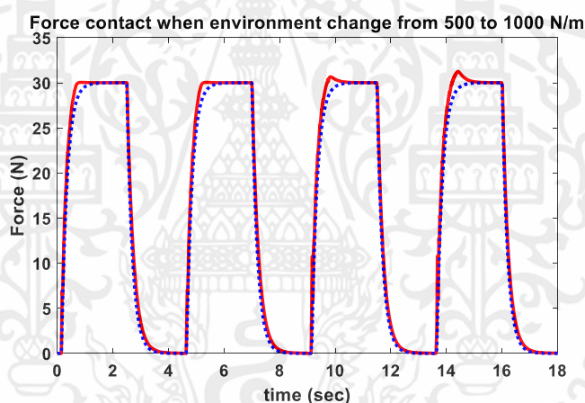
รูปที่ 4.26 ผลของแรงกระทำของตัวควบคุมแรงแบบปรับตัวได้เมื่อเปลี่ยนค่านิจสปริงจาก 500 นิวตัน/เมตร เป็น 1000 นิวตัน/เมตร ที่เวลา 9 วินาที
