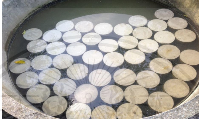
รูปที่ 3.15 การบ่มแท่งคอนกรีตทรงกระบอกในบ่อบ่มคอนกรีต
