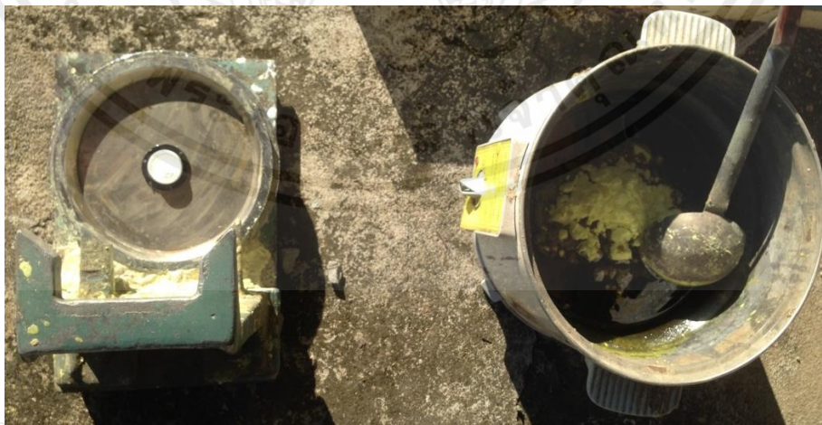
รูปที่ 3.25 แบบหล่อปลายแคป (Cap) และหม้อกำมะถัน
