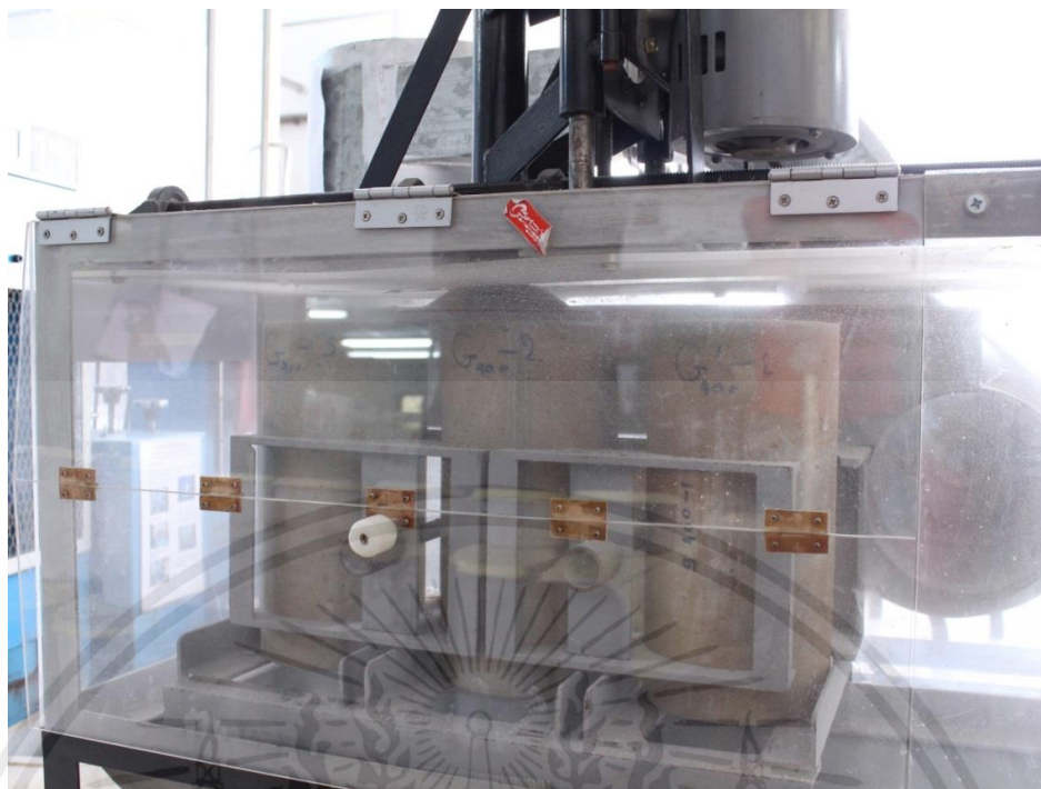
รูปที่ 3.19 การเจียรปลายแท่งคอนกรีตทรงกระบอกด้วยเครื่องเจียรปลาย
