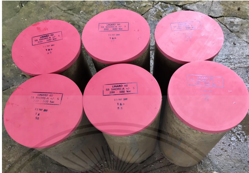
รูปที่ 3.22 การเคลื่อนย้ายแท่งคอนกรีตทรงกระบอกด้วยแผ่นยาง
