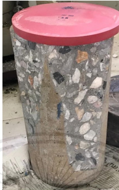
รูปที่ 3.24 การนำคอนกรีตทรงกระบอกผ่านการเคลือบปลายด้วยแผ่นยางเข้าเครื่องกด
