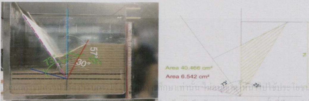
รูป จ.3 พื้นที่ของดินที่มีอิทธิพลต่อการวิบัติของโครงสร้างกันดินแบบ single wall ครั้งที่ 3
