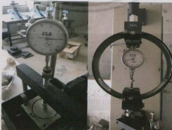
รูป 3.3 เครื่องมือในการหามุมเสียดทานภายในด้วยแรงเหือนโดยตรง
