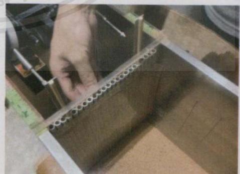
รูป 3.16 เททรายตัวอย่างลงในแบบจำลอง รูป 3.17 ติดตั้งโครงสร้างกันดินพร้อมปรับระดับโครงสร้างให้ได้แนวตั้ง
