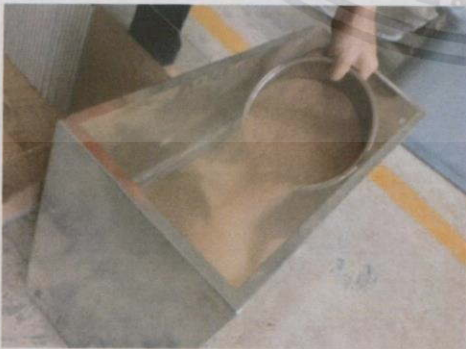
รูป 3.16 เททรายตัวอย่างลงในแบบจำลอง รูป 3.17 ติดตั้งโครงสร้างกันดินพร้อมปรับระดับโครงสร้างให้ได้แนวตั้ง
