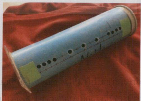
รูป 3.15 อุปกรณ์ปล่อยทราย (sand dropper)
