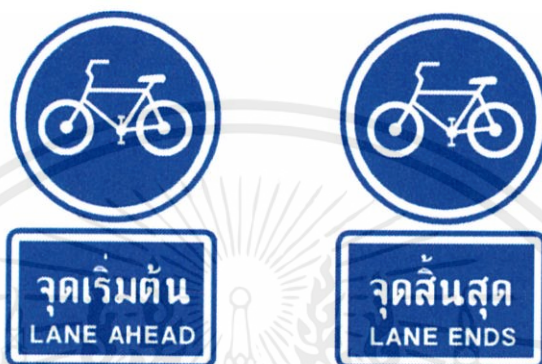
รูปที่ 2.24 แสดงป้ายช่องเดินรถจักรยานพร้อมป้ายเสริม
