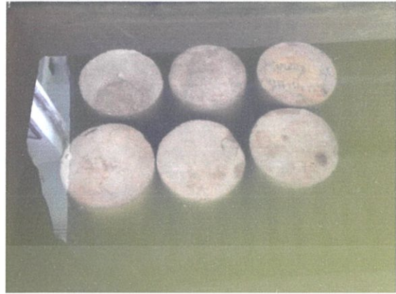
รูปที่ 3.25 การบ่มคอนกรีต
