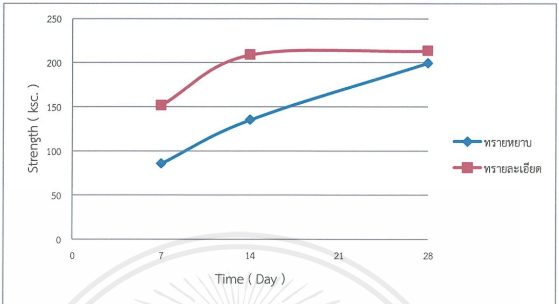
รูปที่ 4.9 กราฟแสดงความสัมพันธ์ระหว่างกำลังรับแรงอัดประลัยของคอนกรีตมวลเบาที่ใช้วัสดุผสมเป็นทรายหยาบและทรายละเอียดที่ผสมสารซูเปอร์พลาสติกไซเซอร์กับระยะเวลาต่าง ๆ ( Prolicon )
