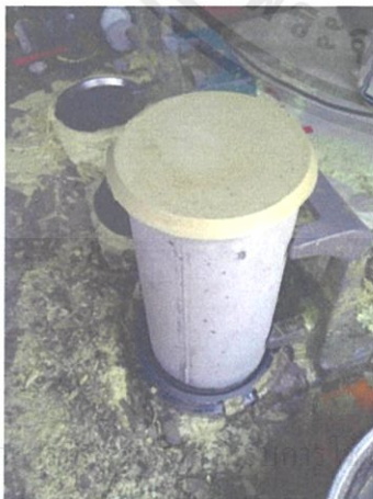
รูปที่ 3.28 การเคลือบหน้าตัด
