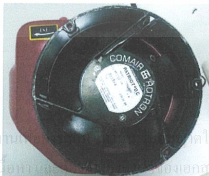
รูปที่ 3.57 การวางforce fan เข้ากับฝาครอบเครื่องยนต์
