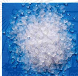
รูปที่ 2.3 ลักษณะ Wide Pore ( Type C ) Silica Gel [1]
