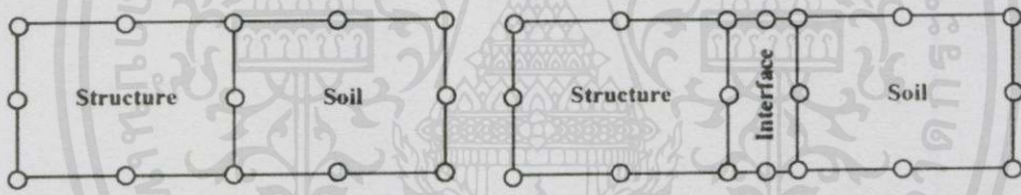
ก) ไม่มีการใช้ชิ้นส่วนต่อเชื่อม ข) ใช้ชิ้นส่วนต่อเนื่องเป็นชิ้นส่วนต่อเชื่อม
