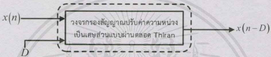
รูปที่ 3.1 บล็อกไดอะแกรมการทำงานของวงจรกรองสัญญาณปรับค่าความหน่วงเป็นเศษส่วนแบบผ่านตลอดไรราน
