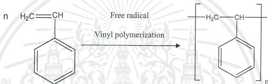
รูปที่ 2.1 การสังเคราะห์พอลิสไตรีน [9]
