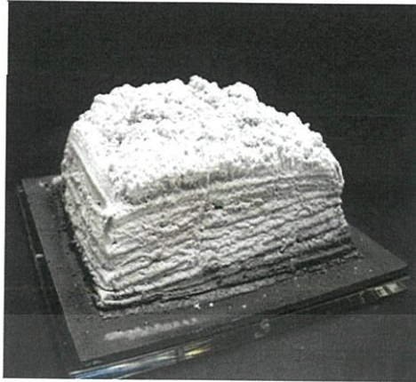
รูปที่ 2.21 ลักษณะการเกิดโฟมของการหน่วงไฟระบบอินตุมสเซนต์ (Intumescent) [21]
