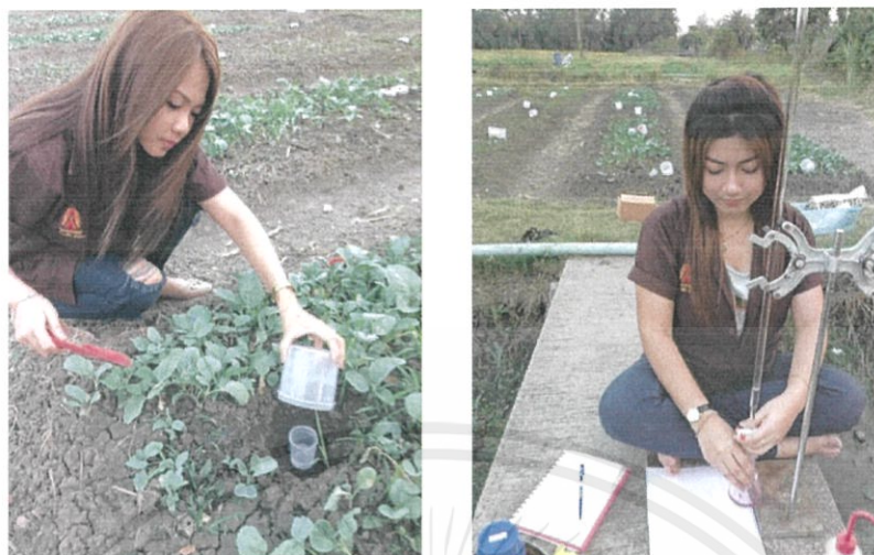
รูปที่ 3.6 การเก็บตัวอย่างก๊าซคาร์บอนไดออกไซด์ (ก) การวาง Plastic chamber (ข) การไทเทรตตัวอย่าง
