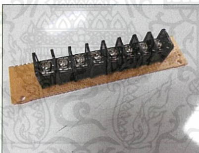
รูปที่ 3.12 Terminal block
