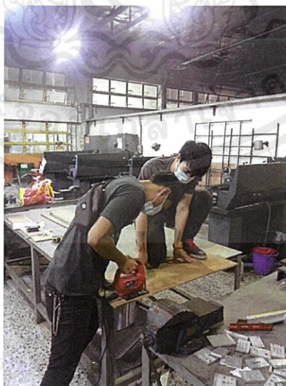
รูปที่ 3.17 ตัดไม้อัดที่วัดขนาดไว้ตั้งขึ้นตอนข้างต้นด้วยเครื่องเลื่อยจิ๊กซอว์
