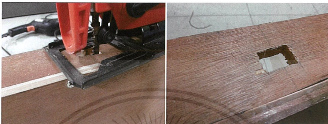
รูปที่ 3.22 เจาะไม้อัดที่ตัดไว้ขนาด 5x100 cm.
