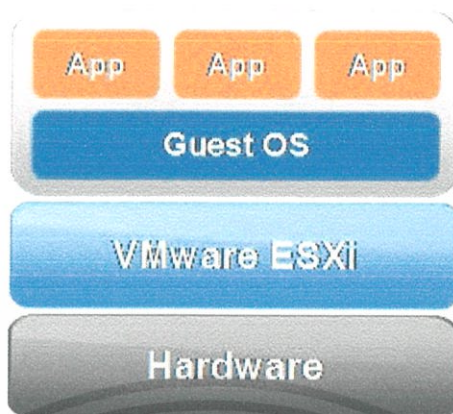
รูปที่ 3.3 แสดงสถาปัตยกรรมของเครื่องคอมพิวเตอร์ที่ใช้VMware ESXi 2
