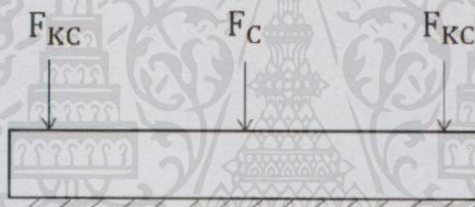
รูปที่ 3.6 แรงกระทำกับเหล็กแผ่นล่างขณะตัดชิ้นงาน
