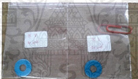
รูปที่ 4.6 ชิ้นงานที่ทำการอโนไดซ์ด้วยแรงดันไฟฟ้า 15 V. ที่เวลา 20 และ 30 นาที ตามลำดับ
