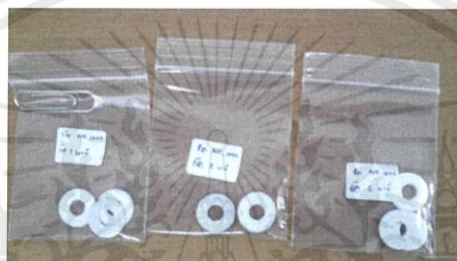
รูปที่ 4.1 การเตรียมด้วยการขัดด้วยกระดาษทรายเบอร์ 1000 และกัดด้วยสารเคมีในเวลา 1,3,5 นาทีตามลำดับ
