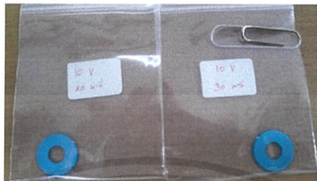
รูปที่ 4.4 ชิ้นงานที่ทำการอโนไดซ์ด้วยแรงดันไฟฟ้า 10 V. ที่เวลา 20 และ 30 นาที ตามลำดับ
