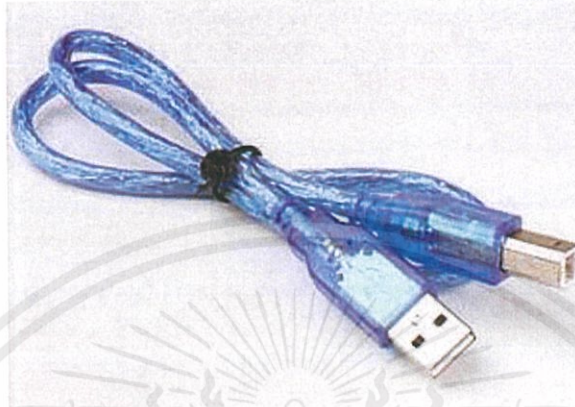
รูปที่ 3.18 แสดงสาย USB Port เชื่อมต่อ Computer กับบอร์ด Arduino UNO R3
