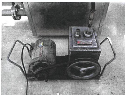
รูปที่ 4.18 ปั๊มสุญญากาศ (Vacuum Pump)
