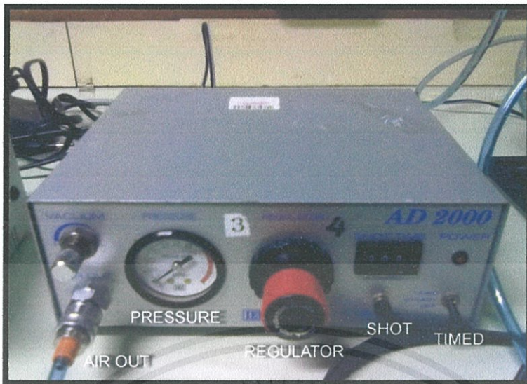
รูปที่ 3.14 ตำแหน่งฟังก์ชันการทำงานต่างๆ ของเครื่องปรับความดันลม
