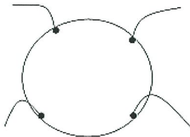
รูปที่ 2.17 ตำแหน่งของจุดสัมผัสบนชิ้นสารตัวอย่างเพื่อวัดความต้านทานแผ่นและสภาพต้านทานไฟฟ้าด้วยเทคนิคแวนเดอร์เพาว์
