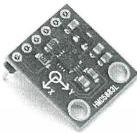
รูปที่ 3.2 วัดสนามแม่เหล็ก HMC5883L
