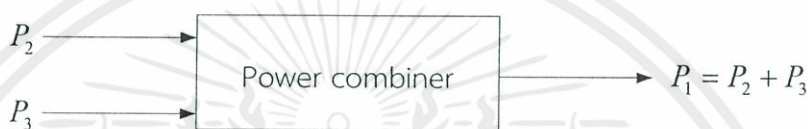
รูปที่ 2.1 ไดอะแกรมการทำงานของอุปกรณ์รวมกำลังสัญญาณ
