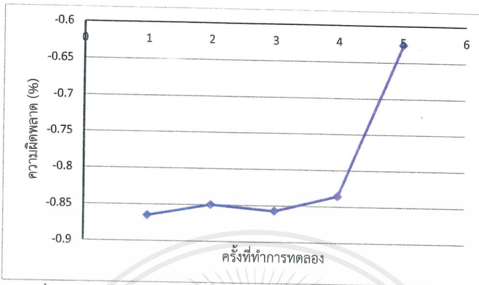
รูปที่ 4.18 ค่าความผิดพลาดของการประมวลผลภาพค่าพื้นที่ด้วยรูปทรงสามเหลี่ยมแบบกำหนดความหนา ขนาดพื้นที่จริง 7.8 ตารางเซนติเมตร
