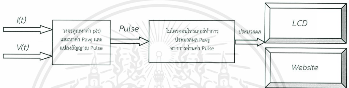
รูปที่ 3.1 รูปแบบวงจรมิเตอร์ไฟฟ้าอัจฉริยะต่อเฟส
