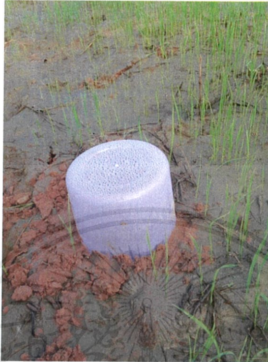
รูปที่ 3 Plastic chamber เก็บตัวอย่างที่นาหว่าน จ.บุรีรัมย์ ตั้งทิ้งไว้ 24 ชั่วโมง
