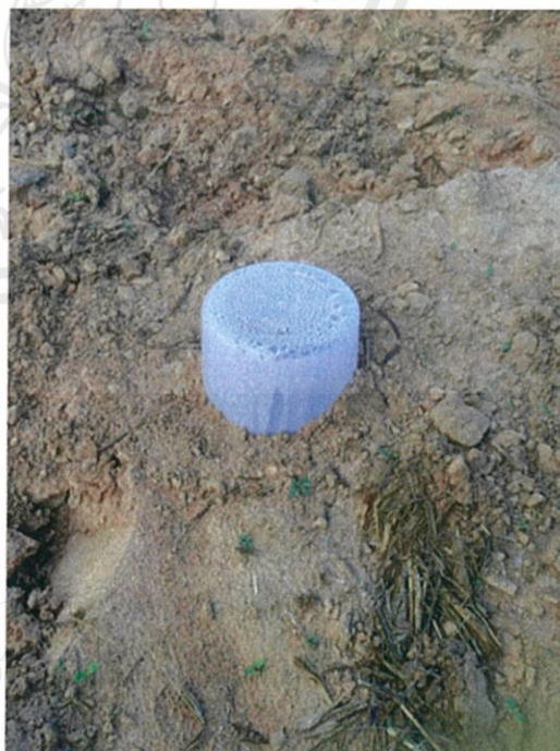
รูปที่ 2 Plastic Chamber เก็บก๊าซคาร์บอนไดออกไซด์ พื้นที่ไม่ปลูกข้าว จ.บุรีรัมย์
