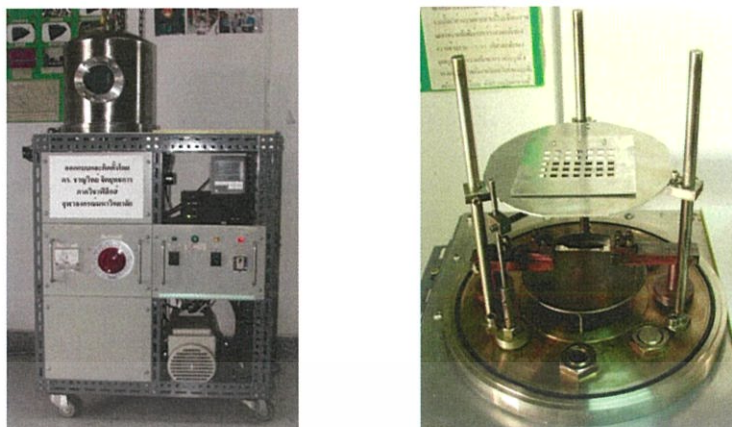
รูปที่ 3.2 อุปกรณ์ที่ใช้ในการเตรียม สิ่งประดิษฐ์รอยต่อวิวิ ธพันธุ์ของฟิล์มบางของสารกึ่งตัวนำ n-CdS/p-CuO โดยการเคลือบฟิล์มบางของสารกึ่งตัวนำ CdS ลงบนแผ่นฐานรองรับที่เป็นฟิล์มบางของสารกึ่งตัวนำ CuO โดยวิธีการระเหยสารเคมีด้วยความร้อนในระบบสุญญากาศโดยการให้อุณหภูมิแก่แผ่นฐานรองรับประมาณ 100 องศาเซลเซียส
