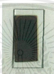
รูปที่ 4.3 พิล์มบางของสารกึ่งตัวนำ CdS ที่เคลือบลงบนแผ่นฐานรองรับที่เป็นฟิล์มบางของสารกึ่งตัวนำ CuO ซึ่งเตรียมโดยวิธีการระเหยสารเคมีด้วยความร้อนในระบบสุญญากาศ
