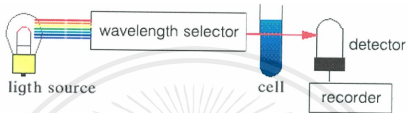
รูปที่ 2.4 แผนภาพเครื่องยูวี-วิสิเบิลสเปกโตรโฟโตมิเตอร์อย่างง่าย [6]
