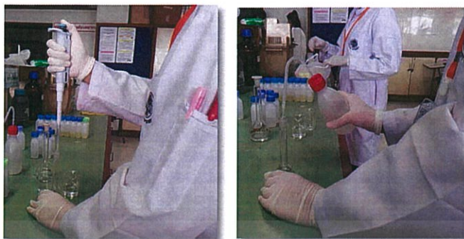
รูปที่ จ.11 การเตรียมสารละลายมาตรฐานของโลหะหนักเพื่อทำกราฟมาตรฐาน
