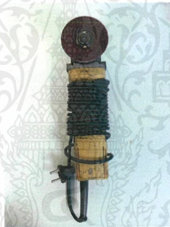
รูปที่ 3.33 แสดงภาพลูกหนูหรือเครื่องเจียร
