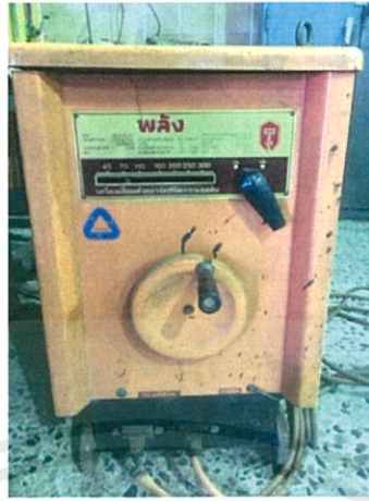
รูปที่ 3.32 แสดงเครื่องเชื่อมด้วยอาร์คชนิดกระแสสลับ
