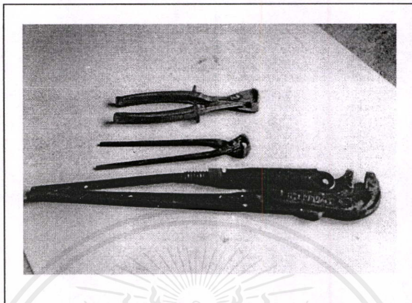
ภาพที่ 2.26 แสดงคีมปากเฉียง (CUTTER PLIERS) คีมปากนกแก้ว (PINCE PLIERS) ใช้ถอนตะปู ตัดตะปู ตัดลวดเวลาผูกเหล็ก คีมค่อม้า (GRIPPING PLIERS) เป็นคีมที่ใช้ในการซ่อมเครื่องยนต์
