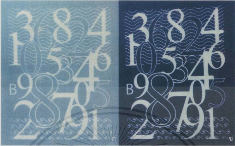
รูปที่ 4.20 ลวดลายที่ได้จากฟิล์มขาวอัดสูตร P*(5)4T6L4B500 (ก) และฟิล์มขาวอัดเกรดการค้า (ข)
