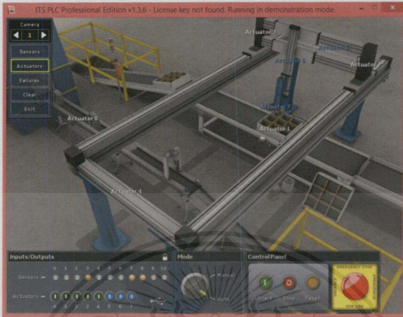
รูปที่ 2.7 แขนจับชิ้นงานที่ตำแหน่งพาเลท (Pallet) ที่รองรับชิ้นงาน
