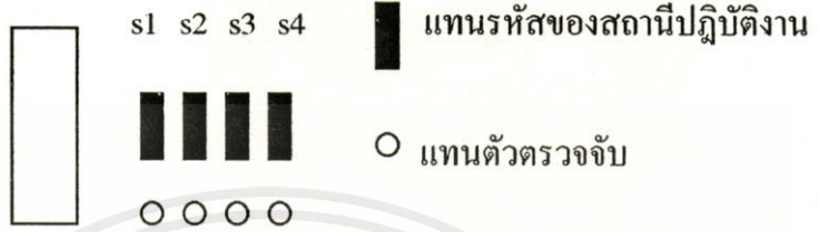
แสดงการตรวจจับสถานีปฏิบัติงานของ AGV
